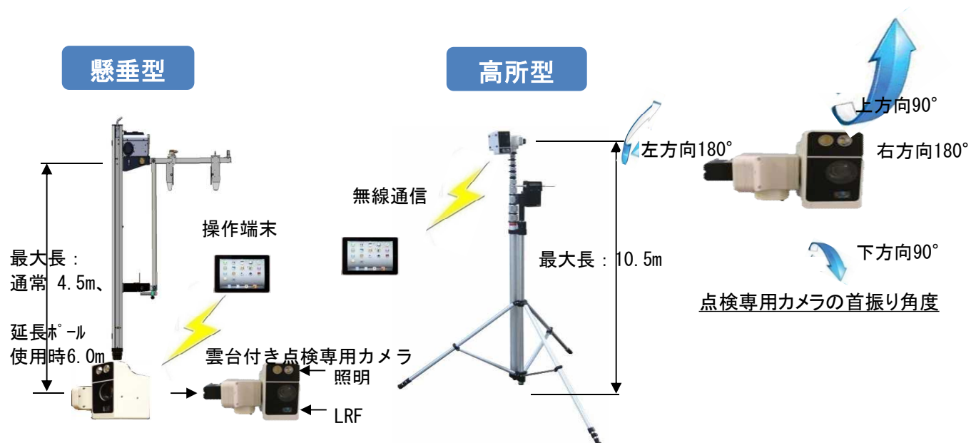
ポールユニットに設置した橋梁点検ロボットカメラ
