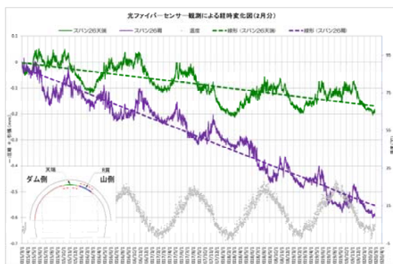
光ファイバーセンサーを用いたひずみ測定結果
