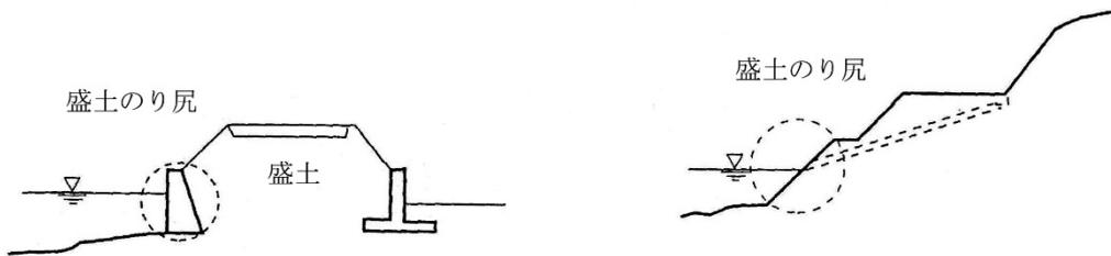
図-5.6.14 盛土のり尻の概念図
