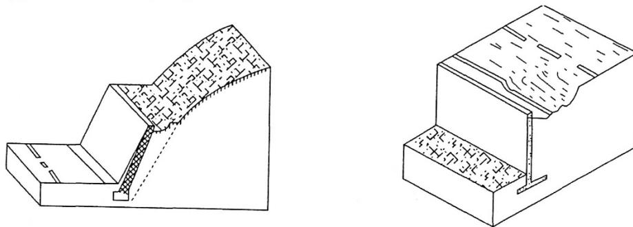
図-5.7.9 背面の陥没・沈下
