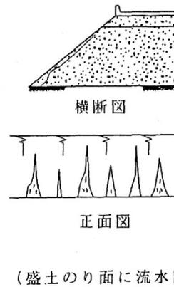
図-5.6.11 盛土のり面の流路跡
