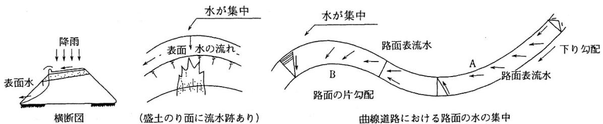
図-5.6.12 路面の水の集中とのり面の変状
