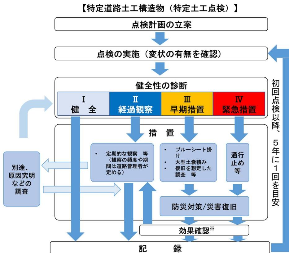
図-12 特定土工点検のフロー図
