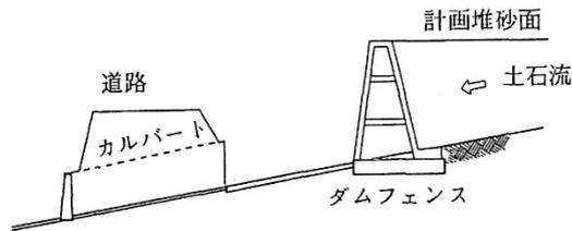
(1)ダムまたはフェンスによる流出土砂の捕捉・
