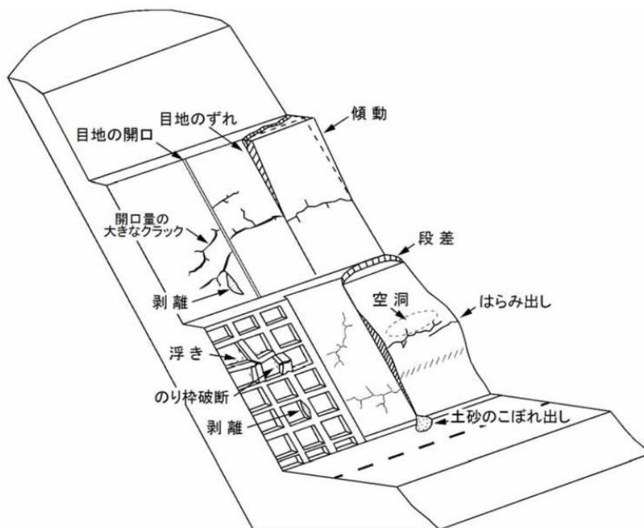
図 切土のり面の点検の着眼点
