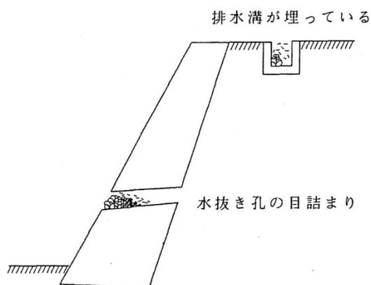
図-5.7.6 排水施設の機能低下
