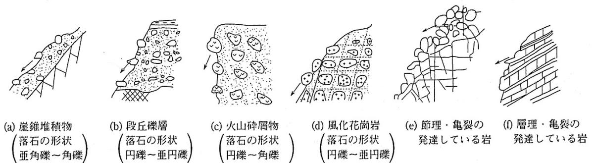
図-5.1.12 支持状態が不安定な浮石・転石の例
