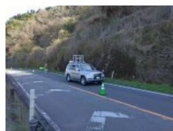
MMS※1を活用した 斜面・のり面点検
