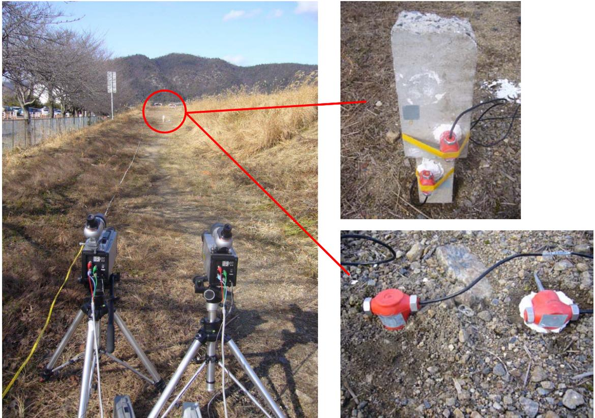
図-9 ターゲットと地震計の設置状況
