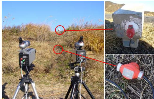
図-7 ターゲットと地震計の設置状況
