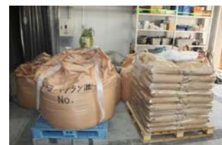
図-2 プレミックス化されたUHP-SHCCの粉体
