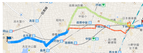
図1 Web-Routing 画面の例(品川区役所→東工大, 色の違いで Hyperpath 構成リンク選択確率の大小を表現)
