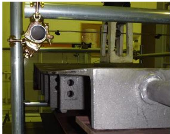
図2-9. 除荷後の塑性変形状態
