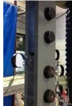
図3-1. すべり係数測定供試体図と試験状況
