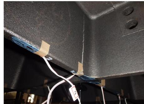
図2-18. 疲労実験後の供試体
