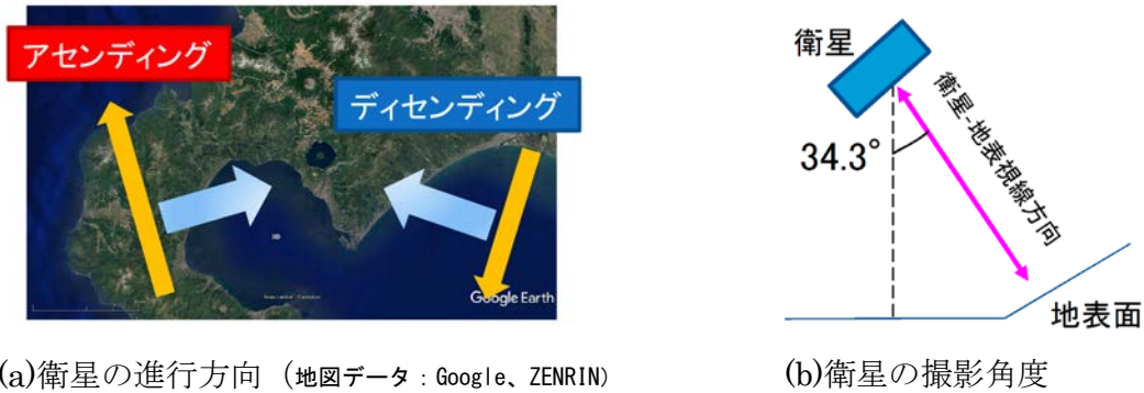
図 6.2.1-5 衛星 SAR の進行方向と撮影方向
