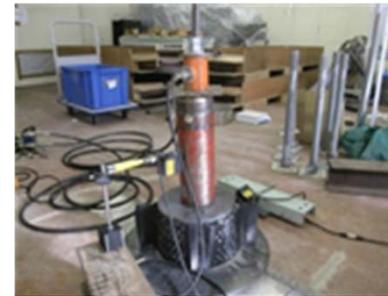
ジオセル圧縮試験 (粒度調整碎石C40-0)
