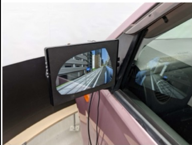
図6 改修内容：左後方の自転車を見えるようにサイドミラーの設置
