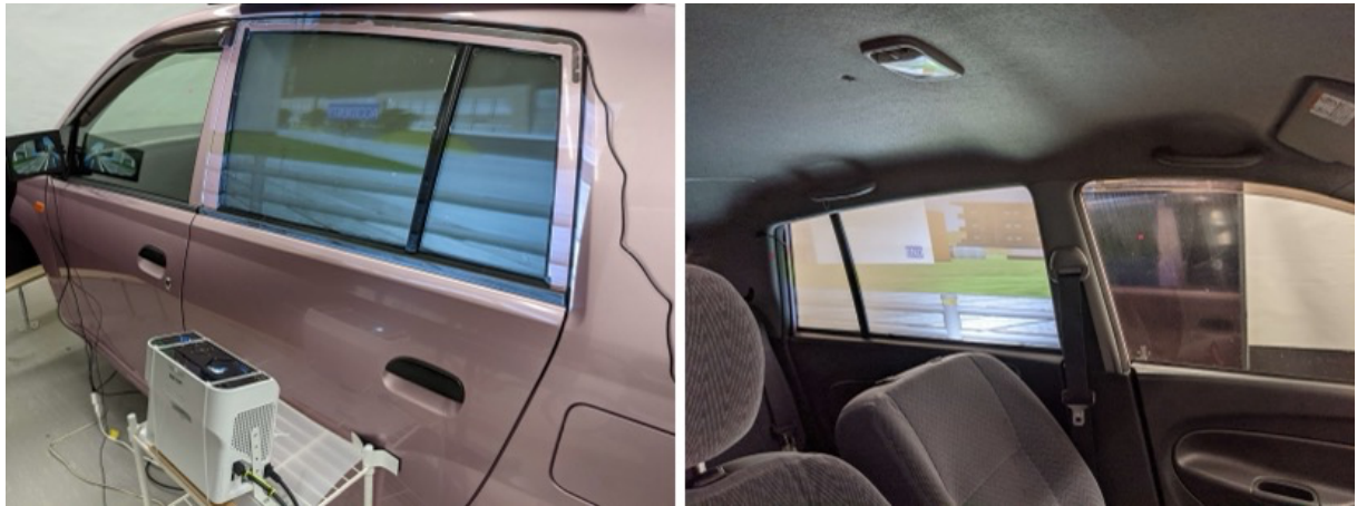
図7 改修内容：左後方の自転車を見えるようにプロジェクタによるガラス面への投影
