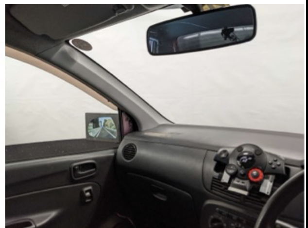
図6 改修内容：左後方の自転車を見えるようにサイドミラーの設置
