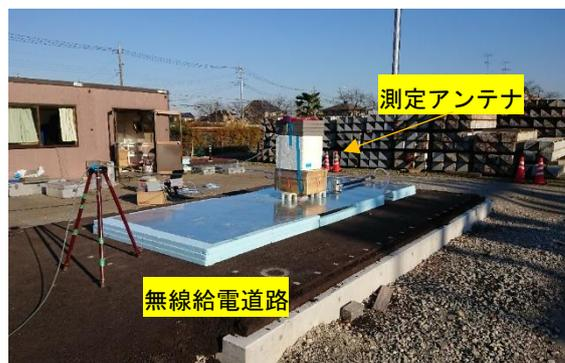
写真 4-1 近傍界における放射電磁界測定
