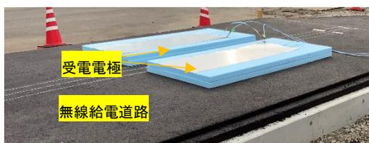
写真 1-1 受電電極検討実験の様子
