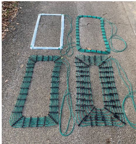
図13. ピッチを変えたコイル
