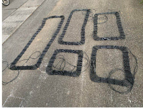
図12. 進行方向の長さを変えたコイル
