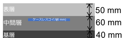
図 29. 直接埋設（型枠7）
