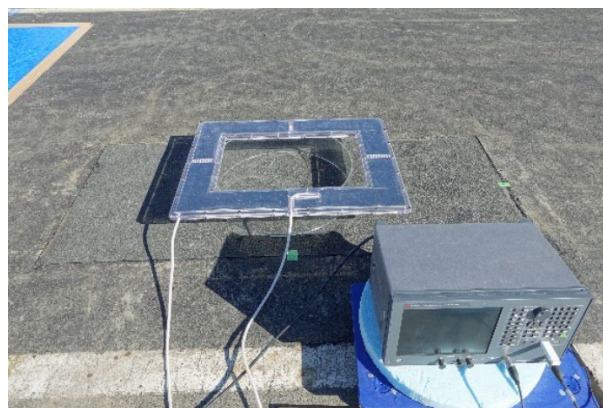
図 60. コイル埋設後におけるVNAによる測定状況
