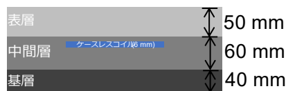
図 29 直接埋設（型枠6・型枠7）【再掲】
