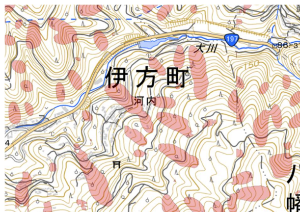
図1 0次谷抽出結果（愛媛県伊方町河内地区）
