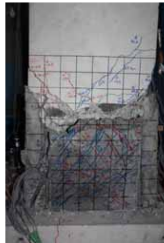
図-11 載荷終了時の破壊状況
