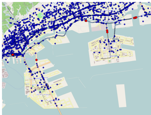
(a) 微妙にポリゴンから外れた事故の例（茨城県）：赤丸はポリゴン外と判定された事故。青丸はポリゴン内と判定された事故。 (b) 海上の橋の上で発生した事故の例（神戸市）：赤丸の事故はポリゴン外と判定されているが、その多くは橋上にある。
