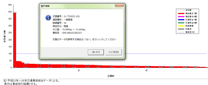
(a) ある国道の ITARDA 区間別の走行台キロ当たり重大事故率（仮想のデータ）：最も事故率の高い ITARDA 区間の属性情報がウィンドウに表示されている。
