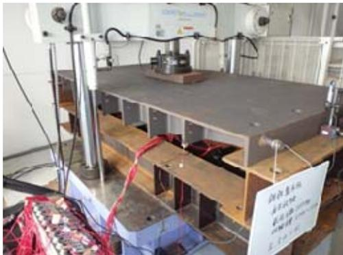
図3 定点繰返し載荷試験
