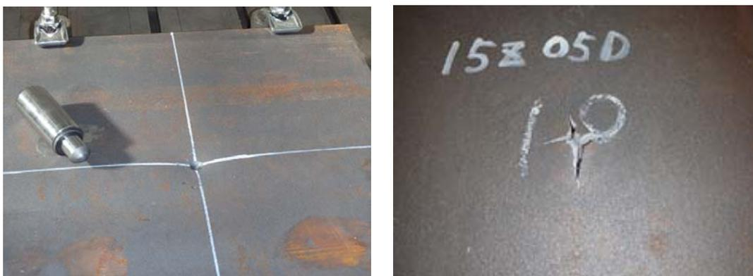
図9 落錘衝撃試験結果
