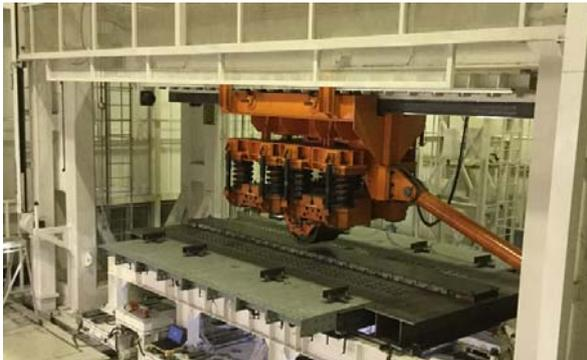
図10 輪荷重走行試験（157kN×200万回）
