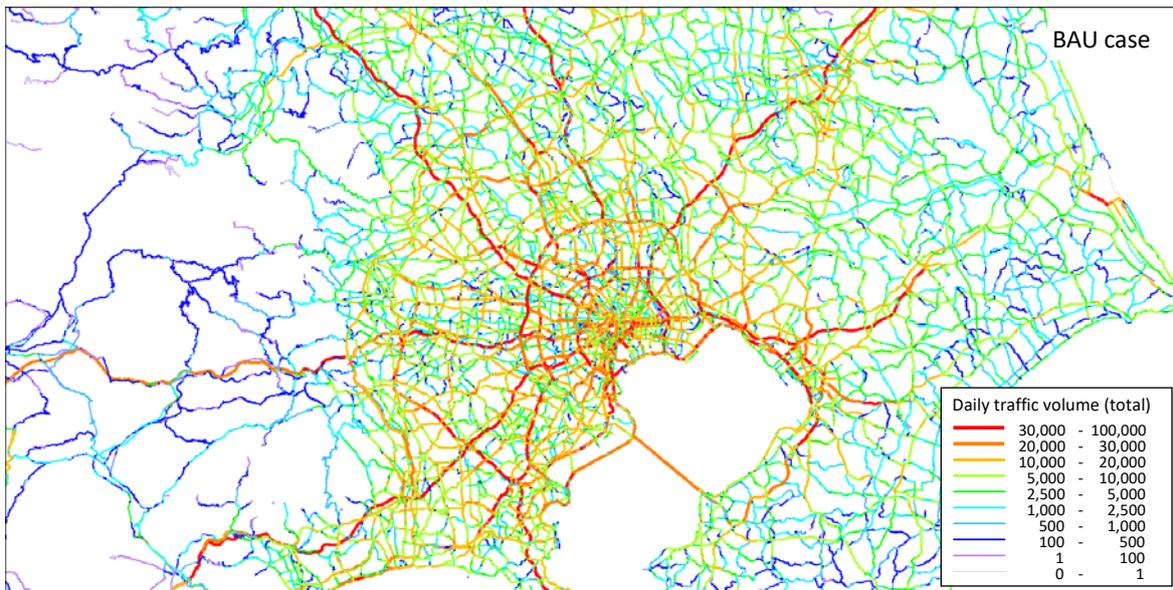
図-47 BAU ケースのシミュレーション結果交通量 (24 時間)
