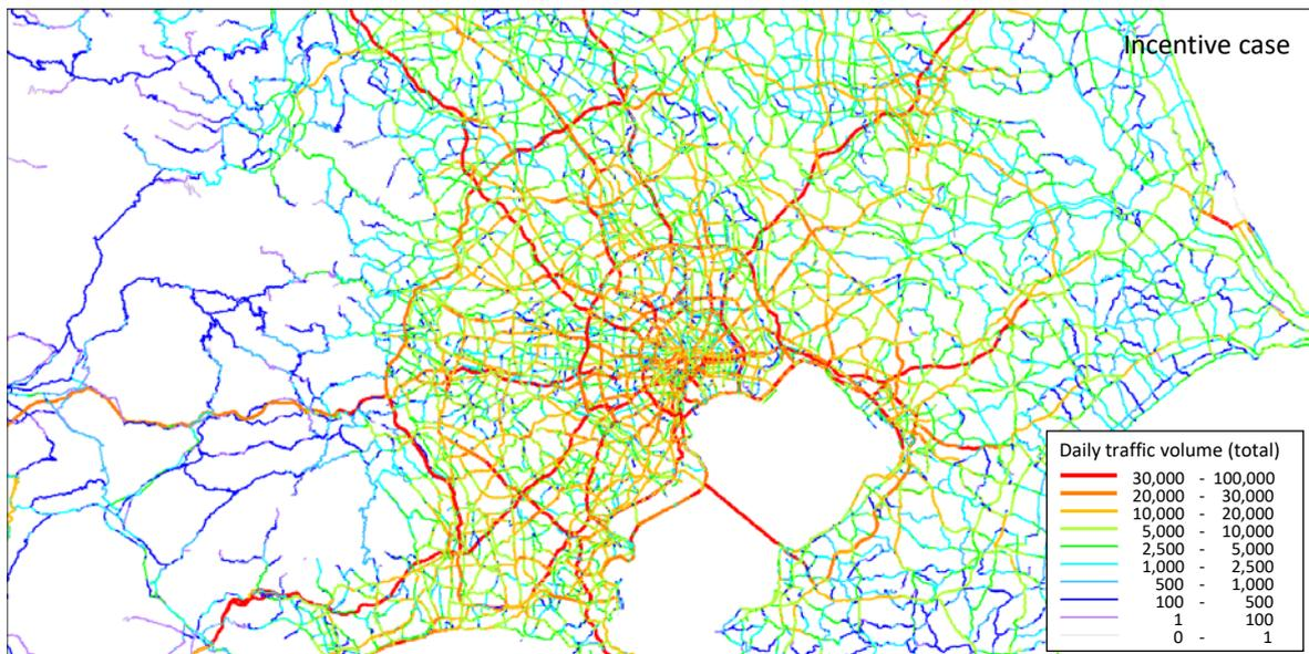
図-57 インセンティブケースのシミュレーション結果交通量 (24 時間)
