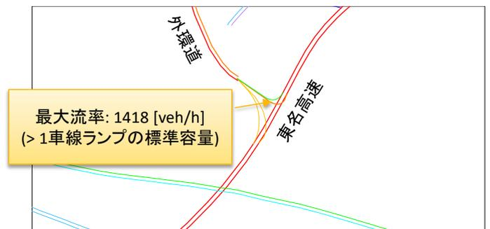
図-32 高速道路ジャンクション部のランプリンクにおけるピーク時交通量
