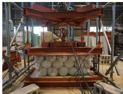
写真 3-4 土のう構造体による実験全景
