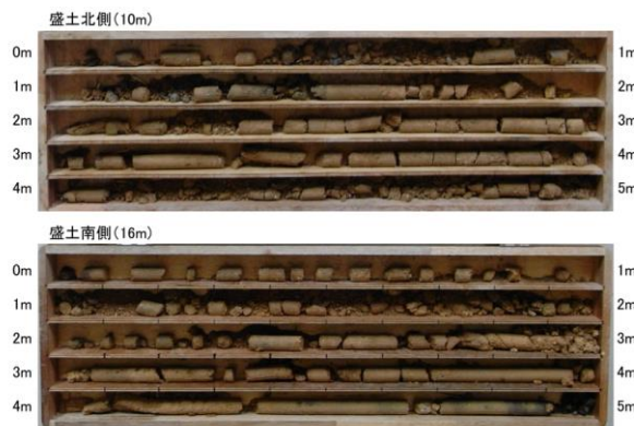
写真 2-3 盛土より採取したボーリング試料
