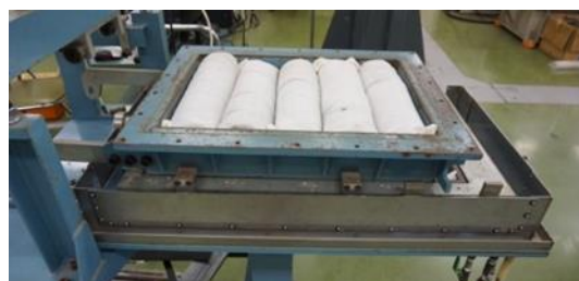
写真 3-2 せん断箱への土のう設置状況
