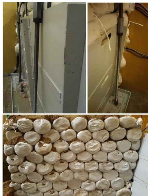
写真 3-9 加振後の土のう構造体の様子
