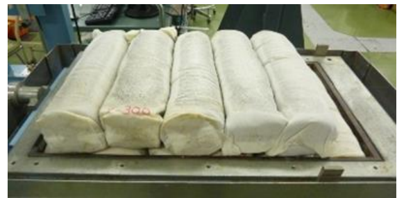
写真 3-3 試験後の土のうの状況
