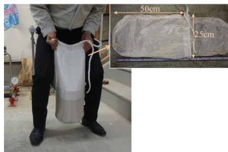
写真 3-7 土のう内への中詰めの様子
