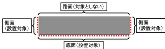
図 2.3 横断方向における薄板供試体の設置対象面
