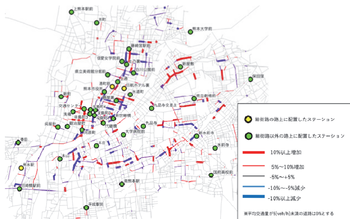
図-3 路上へのステーション設置時の平均交通量増減比率
