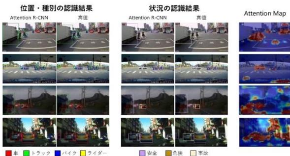
図 2.3-9 Attention R-CNN による事故の認識結果の例
