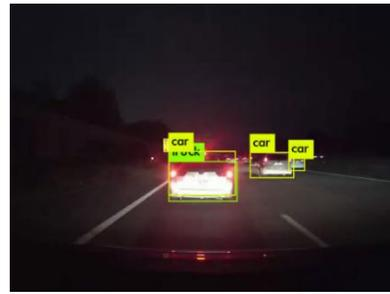
図 2.3-22 エッジ領域抽出で情報なしとして排除された画像のうち、車両が検出された画像の例
