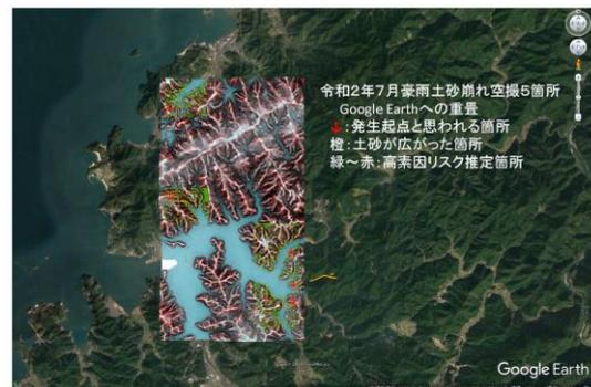
図 3.3-5 令和2年7月豪雨における土砂崩れ5箇所の地形と素因リスク分布
