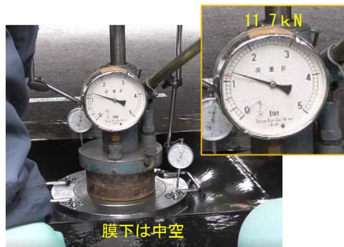
図-4.16 載荷状況(平板載荷)
