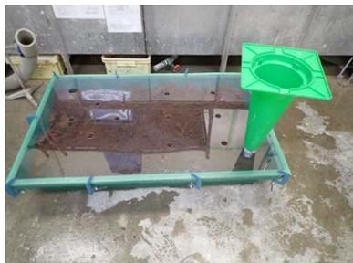
図-4.5 配合 P10(自己充填タイプ)自己充填性確認試験用型枠
