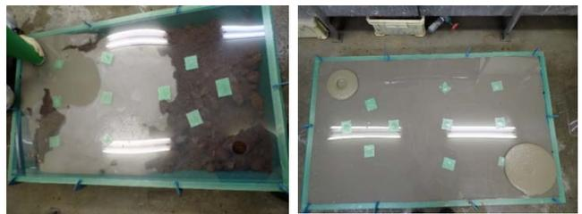
図-4.6 充填試験状況
