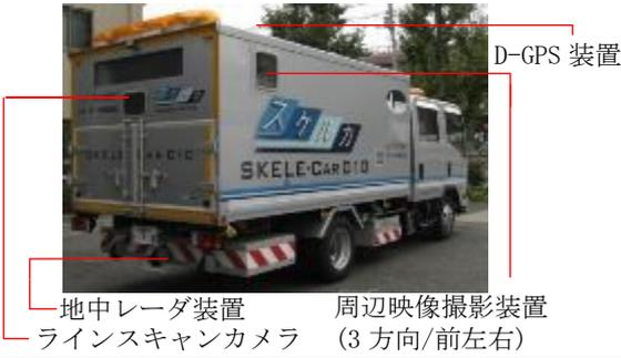
図-3.3 レーダ探査機材(路面下空洞探査車)
