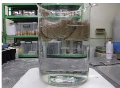
図-4.2 空洞補修用充填材の水中不分離性確認状況
