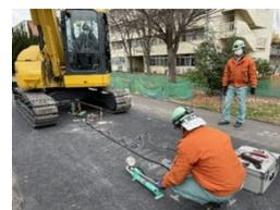
写真-3.3 押し抜きせん断試験状況
