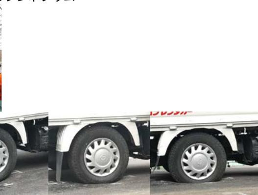
実物大試験道路における陥没デモ（車両後輪直下に空洞あり）
