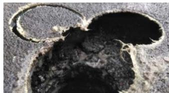
図-4.20 陥没抑制効果の確認(AS層崩落後)
