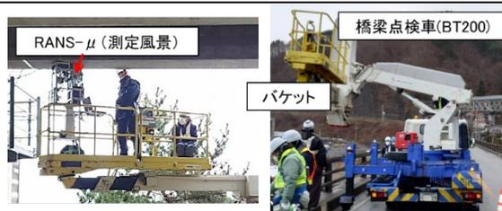
ただし数値目標については、計測した実橋梁に深さ 7cm に塩分濃度  $1.0\text{kg/m}^3$  が存在するケースが無かったため、塩分濃度を調整したコンクリートプレートを、濃度分布を模擬した組み合わせの室内試験による検証で、 $7.5 \pm 1.5\text{cm}$  (深さ 7cm 相当) における塩分濃度  $1.0\text{kg/m}^3$  を 1 時間で検出可能なことを確認した。
