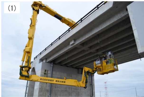
図16 (1) 橋梁下までバケットを移動。(2) 床版裏面近くまでバケットを移動。
