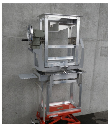
〈塩分計実機モデル〉 実用化に向けたコンセプト検証機。 水平・垂直に対応可能。 写真は筐体のみで、 垂直方向に向けている。
