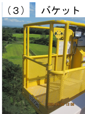
図12 (1)橋梁点検車による塩分測定イメージ (2) バケット式橋梁点検車 (3)バケット
