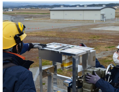
図25 福島ロボットテストフィールドの試験橋梁における、バケット式橋梁点検車を用いた塩分計実機モデルの搭載試験時の組立作業の様子。
