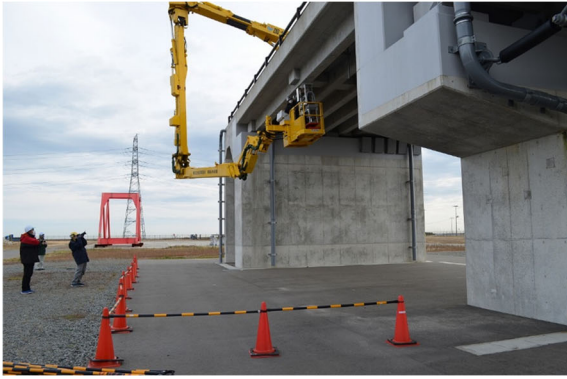
図 2 7 塩分計測試験を実施する耳桁フランジ付近までバケットを移動
