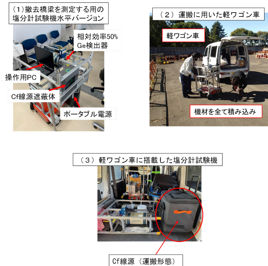
図20 (1) 土木研究所での屋外塩分計測試験に用いた塩分計試験機。(2) 運搬に用いた軽ワゴン車。(3) 軽ワゴン車に機材を全て積み込み。
