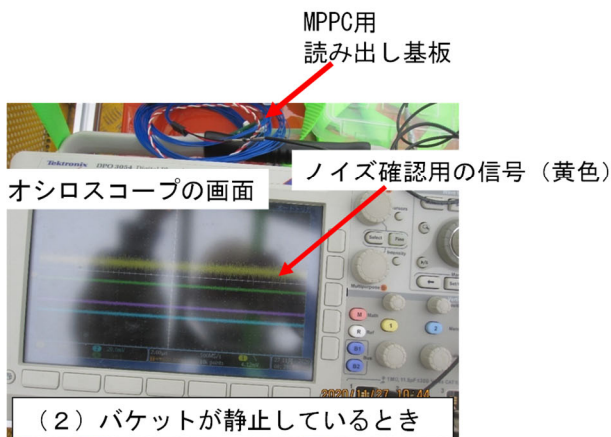
図17 オシロスコープを用いたバケット内ACコンセントを使用した場合のノイズ確認。(1) オシロスコープとヘッドアンプをバケット内に設置。(2) バケットが静止しているとき。(3) バケットを移動や切り返しなど動作させたとき。
