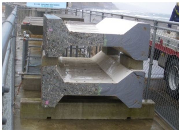
図-3.9 No. 1, No. 3 試験体の継続暴露の状況 (名立大橋暴露試験場)
