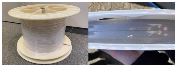
図-5.28 接着剤により貼付した光ファイバーケーブル
