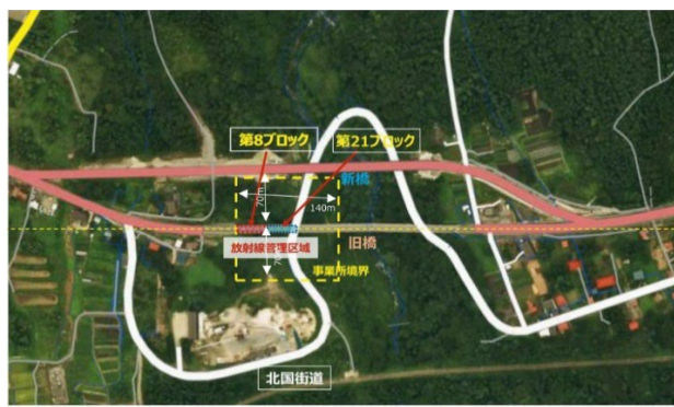
図-2.8 放射線試験時の妙高大橋旧橋周辺管理区域・事業所境界設定予定図
