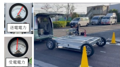
図-3 走行中給電実験
