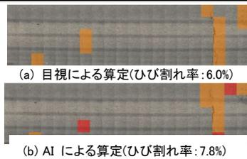
図 1 ひび割れ率の算定結果
