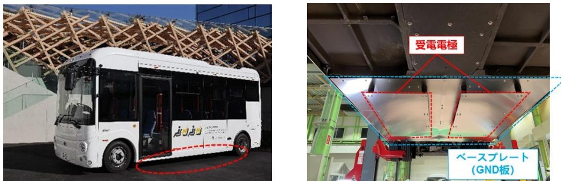
図-32 商用車（EVバス）への受電装置搭載イメージ\*
