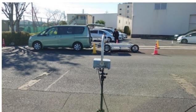
図-29 放射妨害波の測定風景
