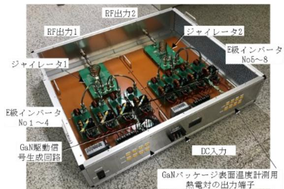
図-10 高周波電源試作機
