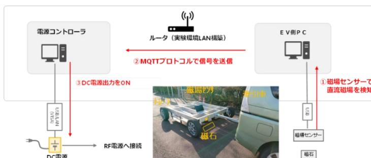
図-25 位置検知および給電制御の概念
