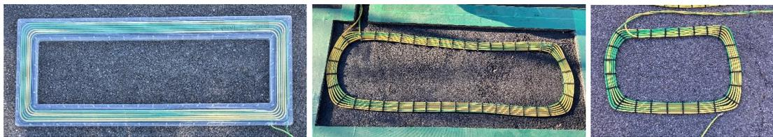
(a)ケースコイル(コイル3, 4) (b)ケースレスコイル, 1700 mm(coil7) (c)ケースレスコイル, 800 mm (coil8, 9, 10)
