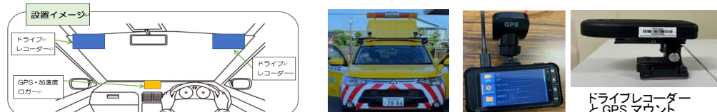
図3 道路劣化計測システムと設置方法
