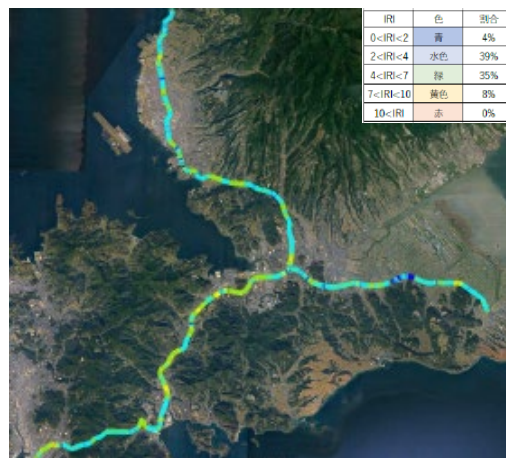
図13 iDRIMSによる計測結果
