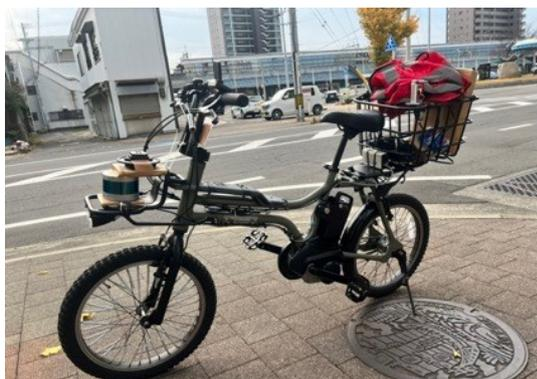
図-3.40 LiDARプローブ自転車
