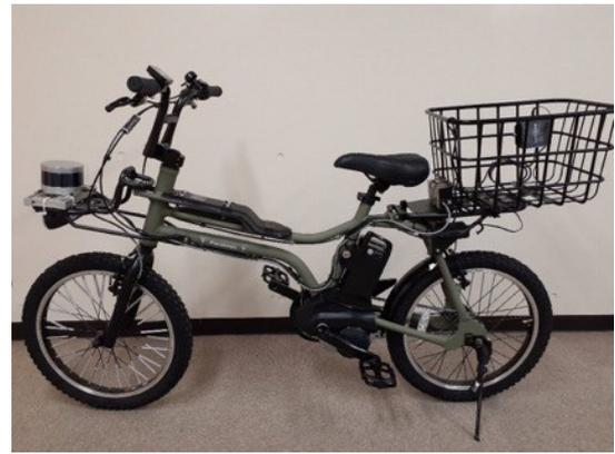
図-3.26 改良したプローブ自転車の概観
