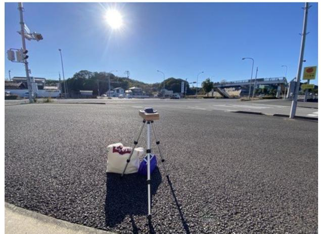
図-3.41 基準局の設置状況
