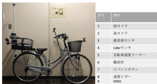
図-3.2 高性能版プローブ自転車
