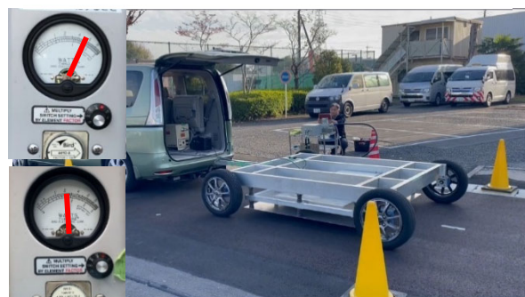
図-3.25 走行中給電(無線給電道路上)
