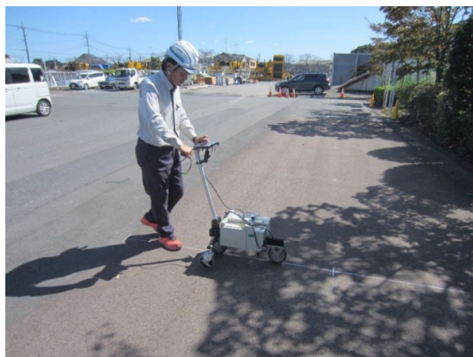
図-4.44 横断プロファイル測定状況
