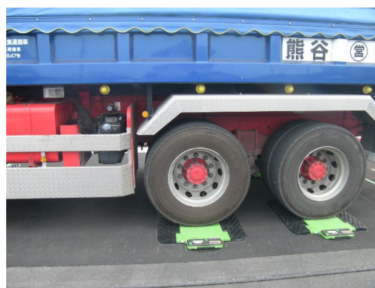
図-4.41 軸重測定状況
