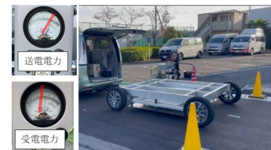
図-3 走行中給電実験
