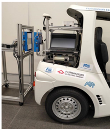
図-2.4 小型 EV への電界結合 WPT 実験風景 18)
