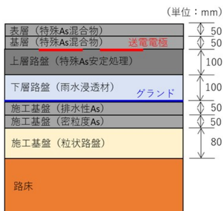
図-7.1 無線給電道路の基本構造例
