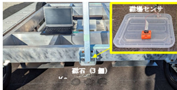
図-5.2 位置検知システムの実験状況
