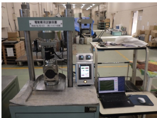
図-4.59 混合物性状試験（マーシャル安定度試験）
