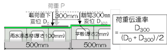
図-4.5 荷重伝達率の評価方法
