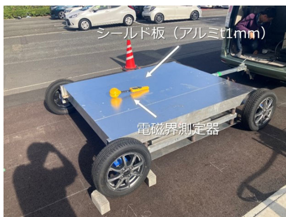
図-6.4 近傍界測定(シールド有り)
