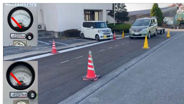
図-3.24 走行中給電(道路進入前)
