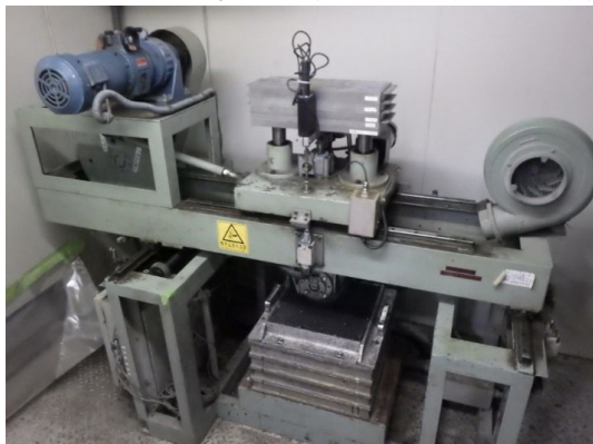
図-4.60 混合物性状試験(ホイールトラッキング試験)
