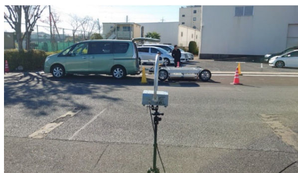
図-6.5 放射妨害波の測定風景
