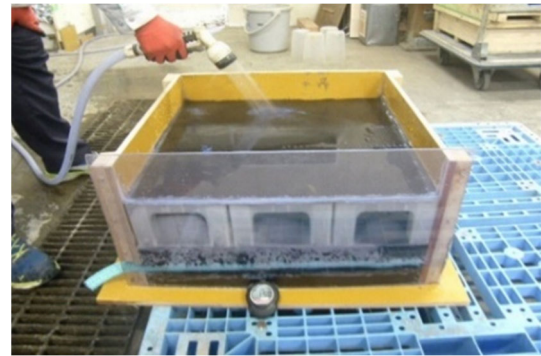
図-4.11 排水能力確認試験
