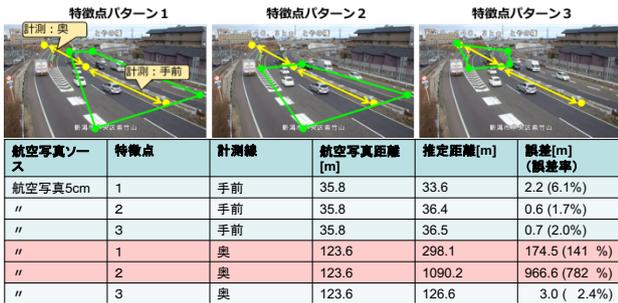
図 4.3-8 特徴点パターン別距離計測結果
