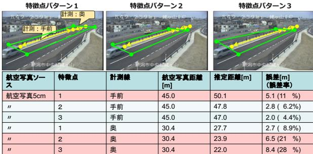
図 4.3-7 特徴点パターン別距離計測結果
