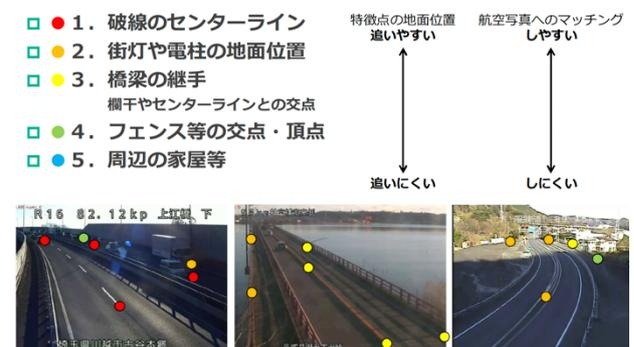
図 4.3-5 特徴点の候補選択基準
