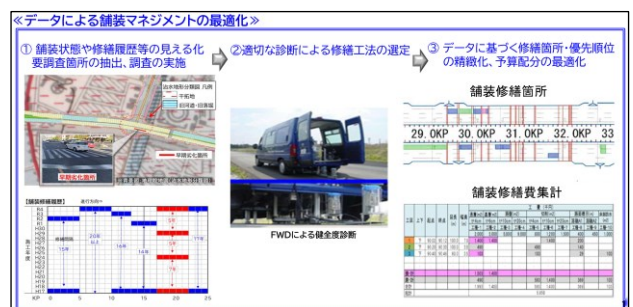
図 2.17 xROAD データの見える化による予防保全型メンテナンスへの移行
