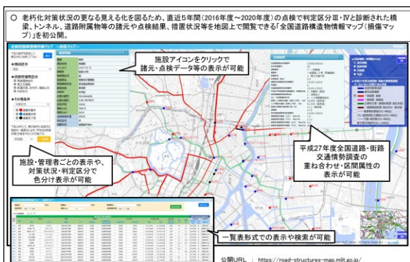
図1.50 全国道路構造物情報マップ（損傷マップ）
