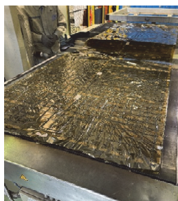
図-4 ネット状補強材 (ホットプレス後)
