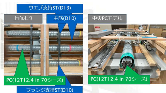
図23 ポステン式PC模擬試験体
