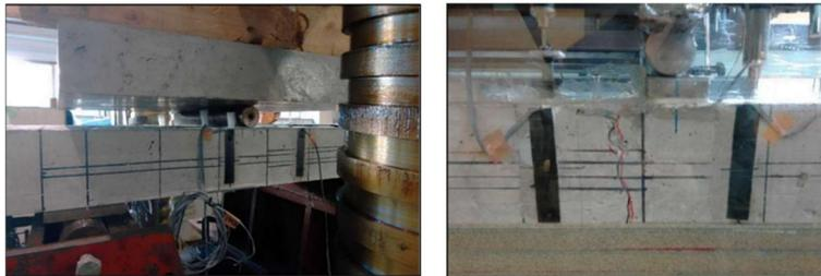
写真 B-1 3点曲げによるひび割れ導入（左）、発生したひび割れの様子（右）
