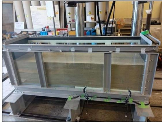
写真 B-4 実験に使用した土槽
