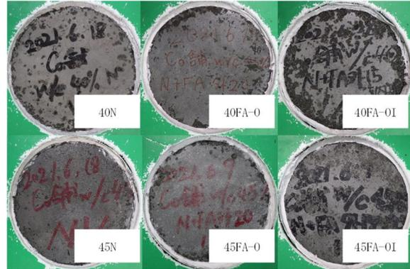
写真 2.1-1 試験後のスケーリング状況
