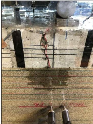
写真 B-8 目地部への注水後の路盤の様子
