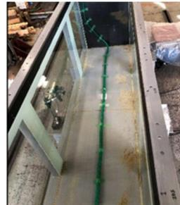
写真 B-5 飽和路盤作成時の様子 (左), 土槽のパイプ染色粒子の層の様子 (右)
