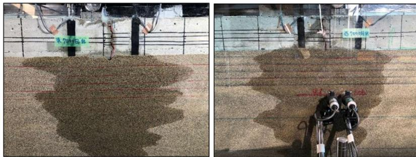
写真 B-9 載荷終了後の路盤（東側：左写真）載荷終了後の路盤（西側：右写真）
