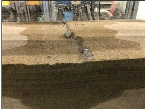
写真 B-12 コンクリート片や粒子と載荷終了後の路盤表面の様子
