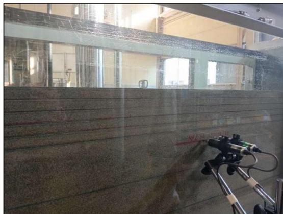
写真 B-6 染色粒子による層分けの様子
