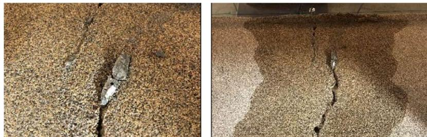
写真 B-10 コンクリート片や粒子（左写真）載荷終了後の路盤表面の様子（右写真）
