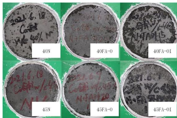
写真-1 試験後のスケーリング状況
