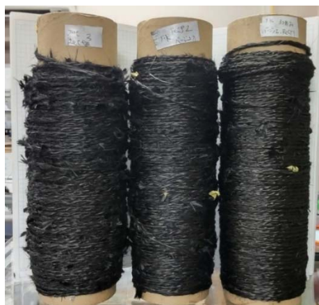
図-2.6 三つ編みした ReCF のストランド (左からリサイクル率 100%, 66%, 33%)
