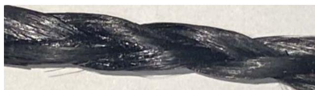
図-3.1 三つ編み状のストランドの拡大写真
