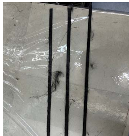
(b)幅約5mmに切断したReCF
