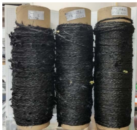
図-3.2 三つ編みしたReCFのストランド（左からリサイクル率100%, 66%, 33%）
