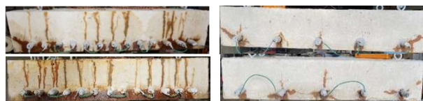
図3.15 スラブ試験体側面のひび割れ状況
