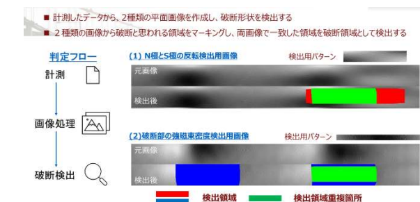
図 4.22 テンプレートマッチングを実施した例
