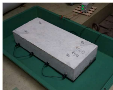
図3.13 電食試験時の実施状況
