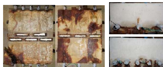
図3.16 梁試験体のひび割れ状況
