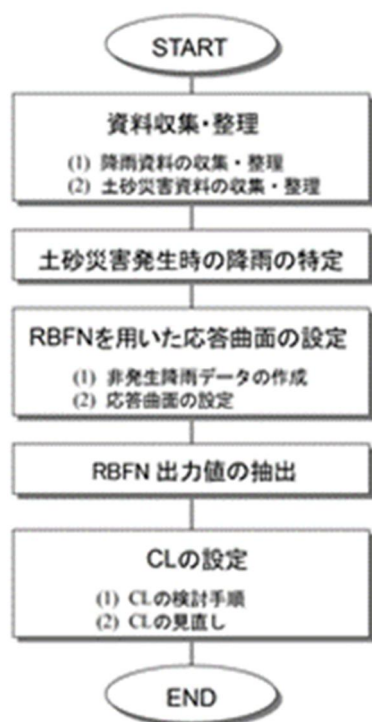
図4-1 RBFNを用いたCLの設定フロー(4-1)
