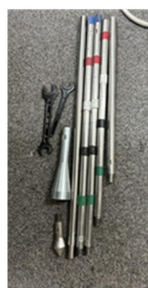
図 6.9 簡易貫入試験機
