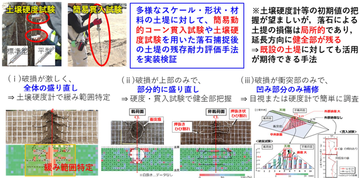
図 2.2 落石捕捉後の土堤の残存耐力評価手法（原位置試験）の提案・検証
