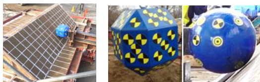
図 4.1 終局状態・終局外力の検討：静的載荷模型実験の様子：土堤モデル（一番左）と 2 形状の重錘（EOTA 型と球型の重錘）
