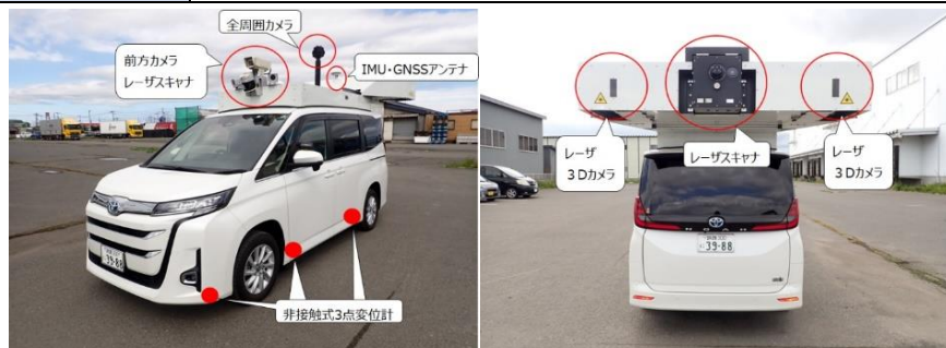
機器設置状況
