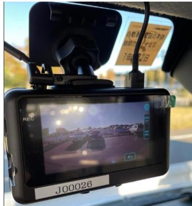
フロントガラスの上部中央付近に取り付けブラケットを固定しドライブレコーダーを設置
