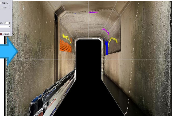
CrackDraw21による三次元化
