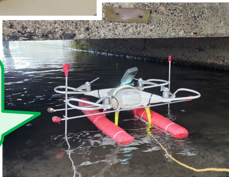
水面に浮かび、障害物を飛越えて撮影することが可能
