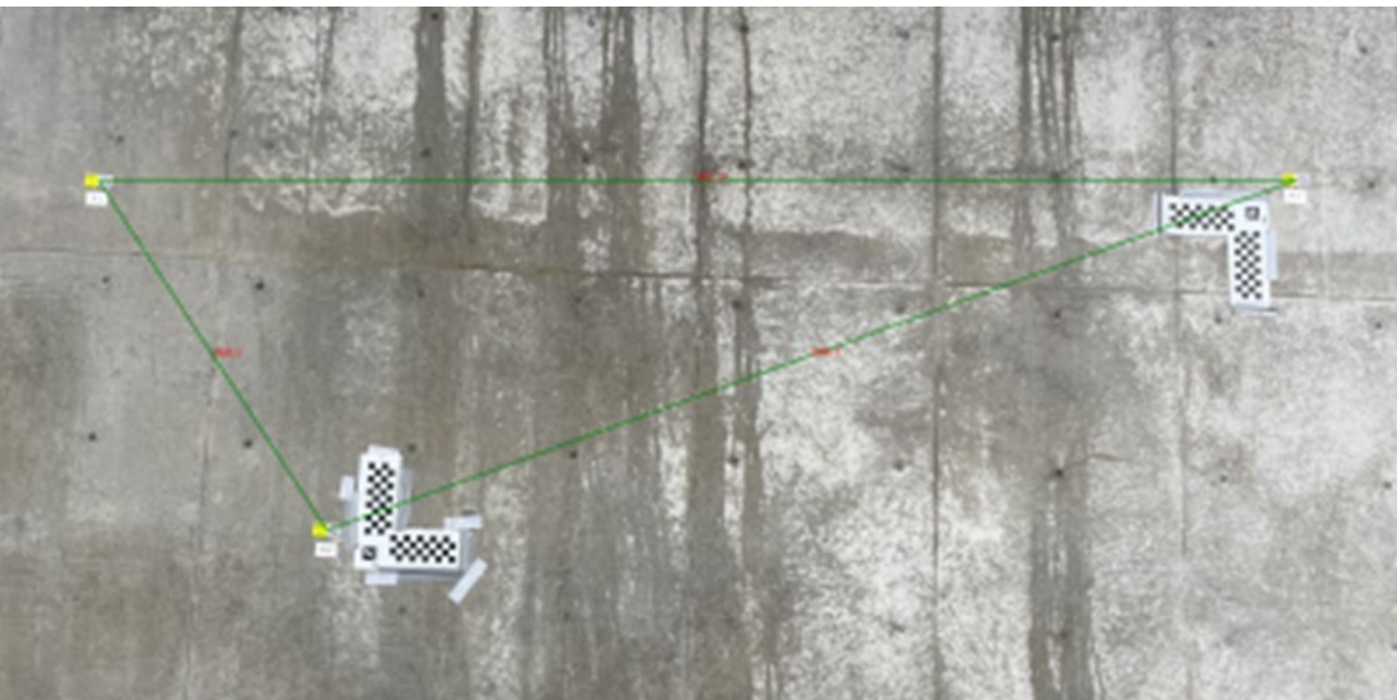
「計測ソフト上での距離算出結果(緑線が指定区間)」
