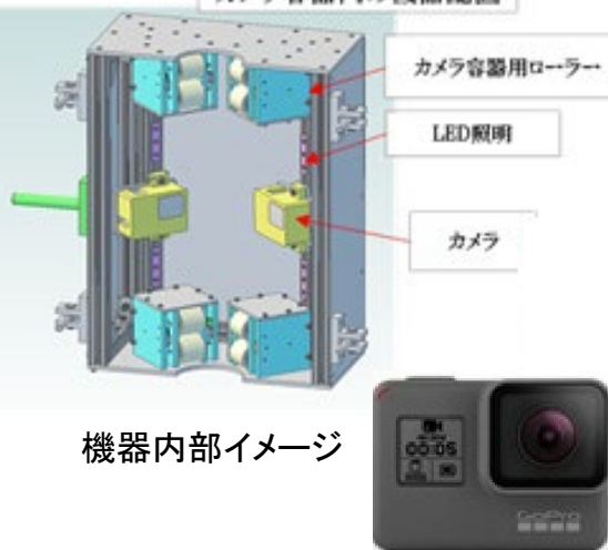
カメラ容器内の機器配置
