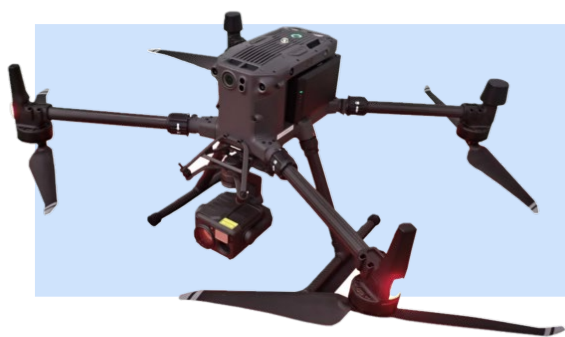
対象部材を撮影 (ドローン:Matrice300RTK)
