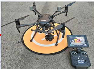
赤外線カメラ・可視光カメラ搭載ドローン
