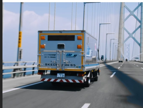
電磁波レーダー探査車 (スケルカー)
