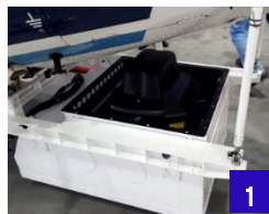
航空レーザー測深機器構成及び移動装置(回転翼機)への搭載状況
