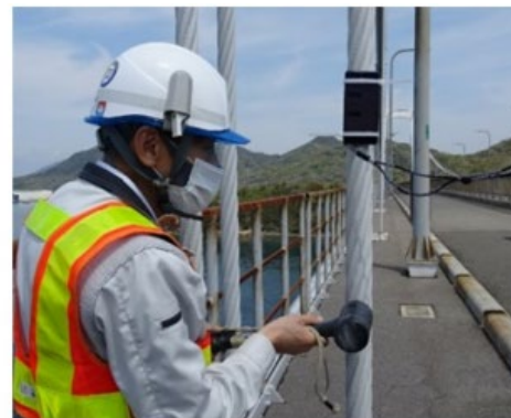
吊橋ハンガーロープ計測状況
