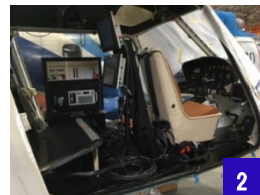
航空レーザー測深機器構成及び移動装置(回転翼機)への搭載状況
