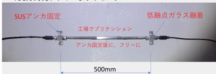
FBG方式光ファイバひずみセンサ
