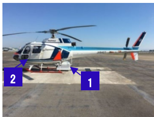
航空レーザー測深機器構成及び移動装置(回転翼機)への搭載状況
