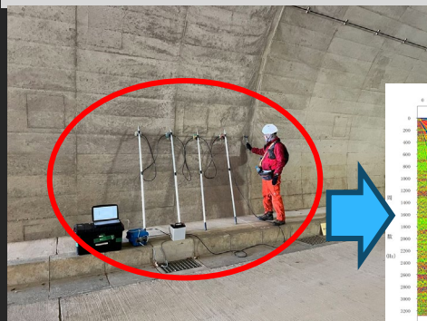
現地の表面波探査状況
