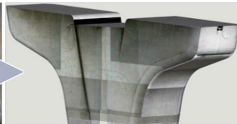
ひび割れの3次元鳥観図
