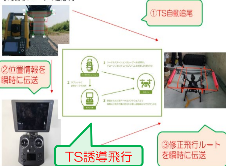
【TS誘導ドローンの仕組み】
