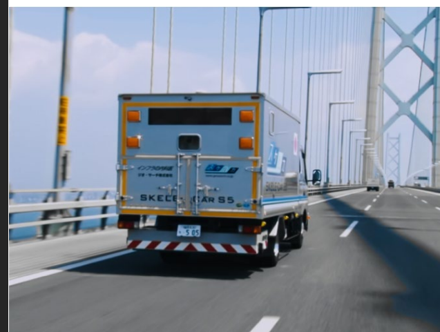
電磁波レーダー探査車 (スケルカー)
