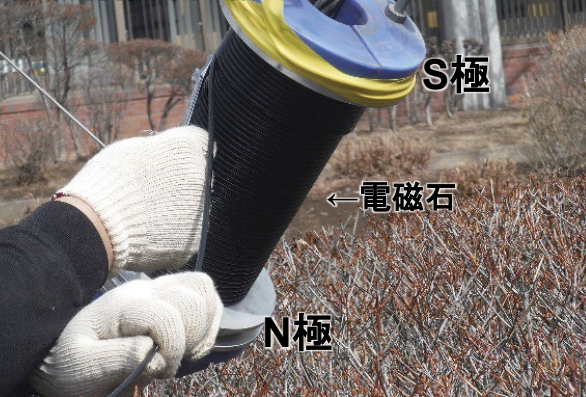
定点(腐食率)測定
